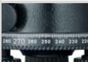
Horisontell fininställning för exakt placering av laserstrålen.
