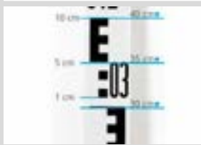
Mätskala med E-indelning
